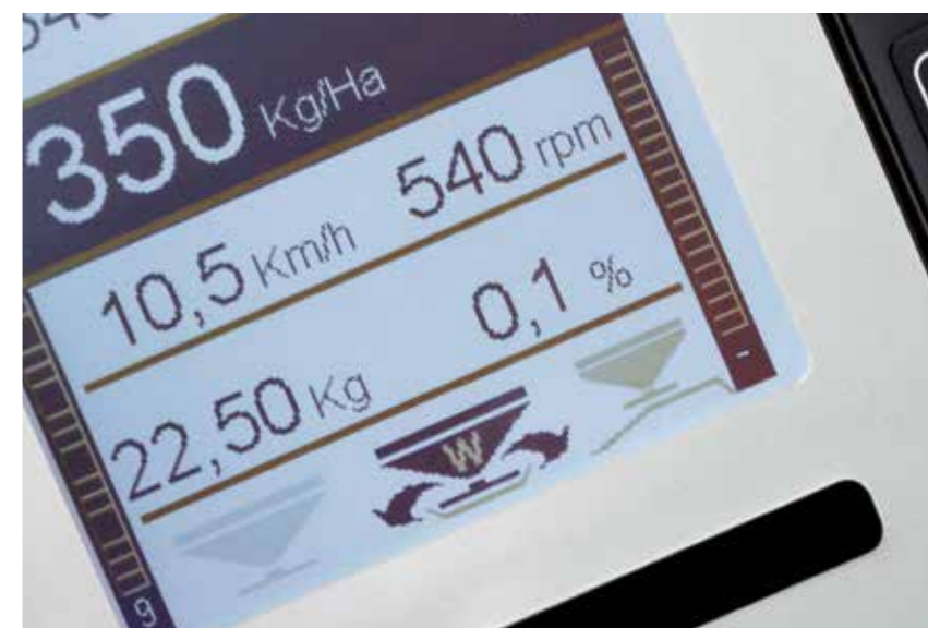
Розподільники, обладнані технікою зважування, автоматично калібруються під час руху, тому немає необхідності в ручному тестуванні сипучості.
