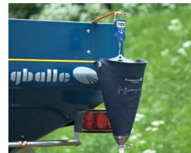
S-індикатор простий у використанні, повний тест конкретного добрива здійснюється протягом кількох хвилин.
