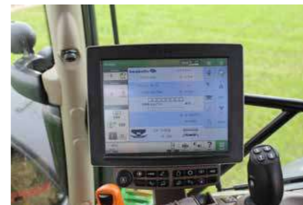
На незалежних від швидкості розподільниках, оберти ВОП контролюються безпосередньо на дисплеї.
