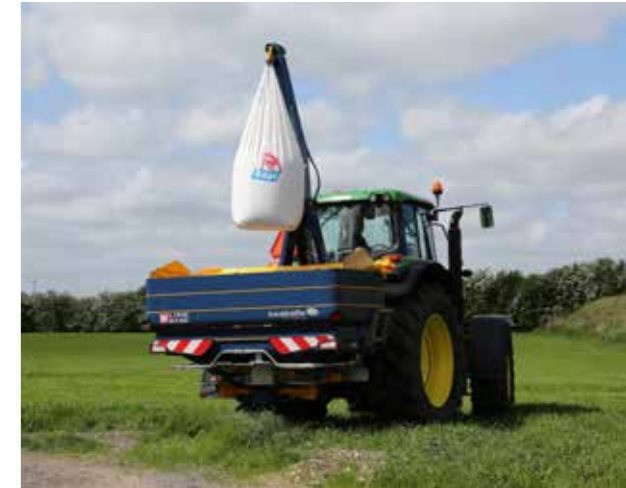
ВХЛ 1300 може підняти до 1300 кг і може бути встановлений на розподільнику до 3300 літрів.
