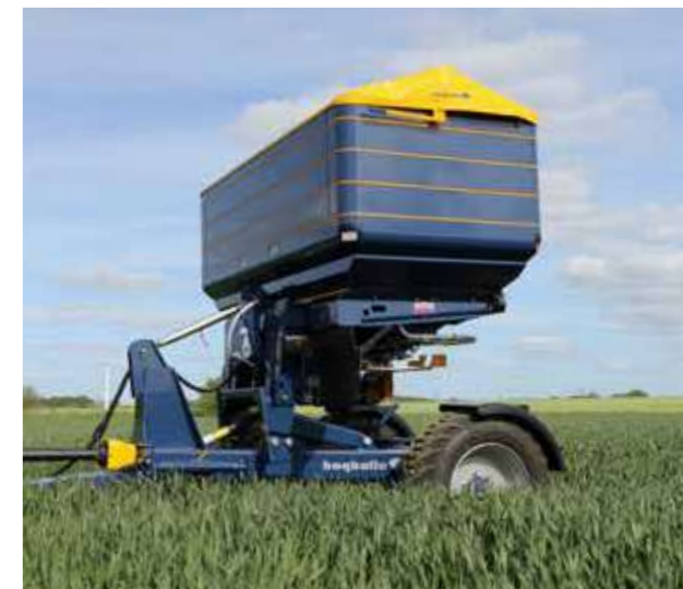
Розподільник можна знімати та використовувати для пізньої обробки високих культур.
