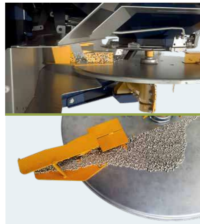
Великі та плоскі розкидаючі диски рівномірно вносять добрива на 180 градусів.
